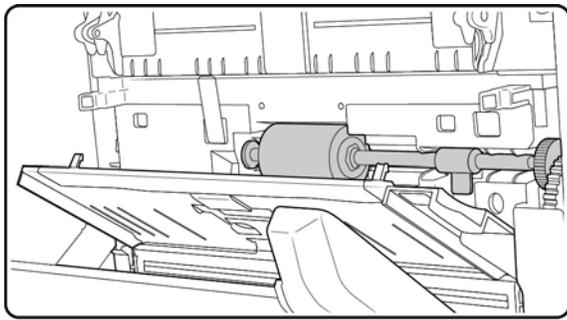
4. El rodillo se mantiene en su posición mediante una lengüeta de bloqueo que gira para bloquearlo y desbloquearlo. Para desbloquear la lengüeta, gírela hacia arriba hasta que la pestaña de bloqueo pequeña esté completamente libre.
