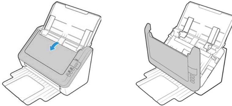
3. Limpie estos rodillos de un lado a otro. Gire los rodillos hacia abajo para limpiar toda la superficie. Limpie con un paño la sección de vidrio en el cuerpo del escáner.
