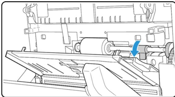
9. Levante la guía de papel hacia arriba y hacia la parte posterior del escáner, y presione suavemente la guía hasta que encaje en su lugar.
