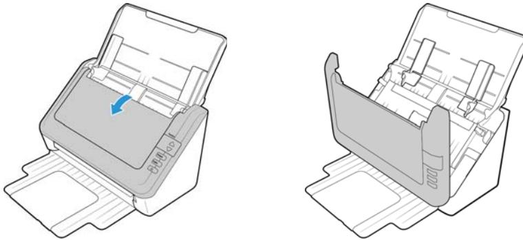
3. Limpe os rolamentos de alimentação e separação de uma extremidade a outra. Gire os rolamentos para baixo e limpe toda a superfície de cada rolamento. Passe o pano na chapa de vidro e de fundo no corpo do scanner.
