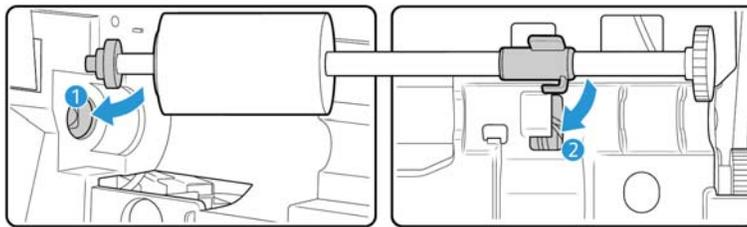
8. Gire a aba de travamento para baixo de modo que o anel de travamento prenda no engate. Não force a aba de travamento para encaixar. Se ela não girar livremente para travar no lugar, verifique se o anel está encaixado corretamente no engate.
