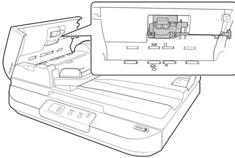
3. El rodillo se mantiene en su posición mediante una lengüeta de bloqueo que gira para bloquearlo y desbloquearlo. Para desbloquear la lengüeta, gírela hacia arriba hasta que la pestaña de bloqueo pequeña esté completamente libre.
