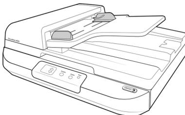
2. Coloque la pila de documentos *hacia arriba* en el alimentador automático de documentos, insertando primero su borde superior.
