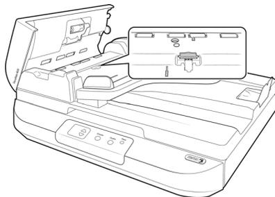
2. Presione la abrazadera plástica que mantiene el ensamblaje de la almohadilla en su posición.
