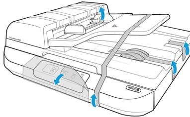
3. Abra la cubierta del alimentador automático de documentos y quite la cinta o la espuma protectora del interior del alimentador. Cierre la cubierta del alimentador cuando haya terminado.
