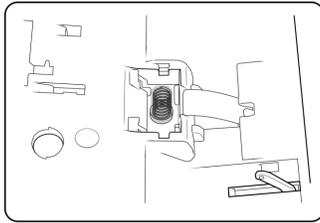
5. Coloque el resorte de tensión nuevo en el escáner.
