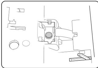
6. Coloque la almohadilla del ADF nueva en el escáner encima del resorte de tensión.
