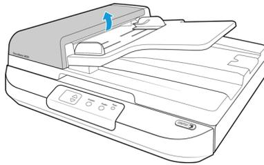
3. Limpie el rodillo de alimentación de lado a lado. Gire el rodillo para limpiar toda su superficie. El rodillo de alimentación está ubicado en la parte inferior de la puerta del ADF.
