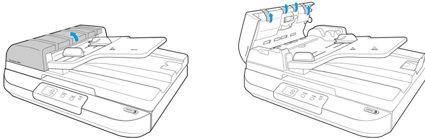
4. Levante la tapa del escáner.
