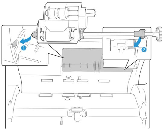
7. Alinee la lengüeta en la pestaña de bloqueo con la ranura del escáner. Use la palanca para girar la lengüeta de bloqueo hasta la ranura del escáner. Presione la palanca hasta que se coloque en su lugar con un clic y bloquee el rodillo en la puerta del ADF.
