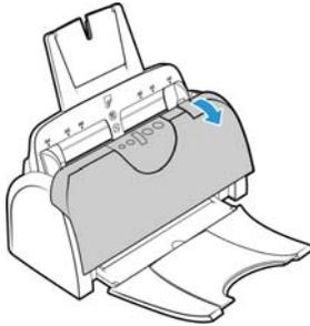
2. Retire la bandeja de entrada de papel. El rodillo está ubicado dentro del cuerpo del escáner detrás de la bandeja de entrada.
