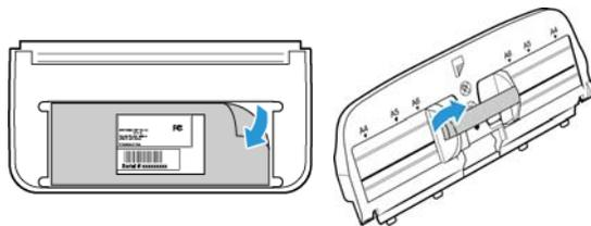
3. Inserte la extensión de la bandeja de entrada en la bandeja de entrada y encaje sus lengüetas en su posición.
