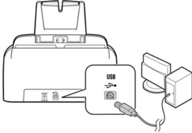
Si el conector no entra con facilidad, asegúrese de estar conectándolo correctamente. No fuerce el conector para realizar la conexión.
