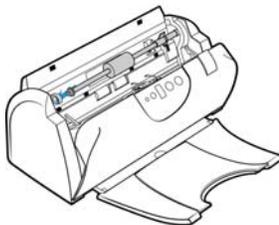
9. Cuando esté seguro de que los engranajes se hayan engranado, gire la lengüeta de bloqueo hacia abajo de modo que la pestaña de bloqueo se enganche en su sujetador.
