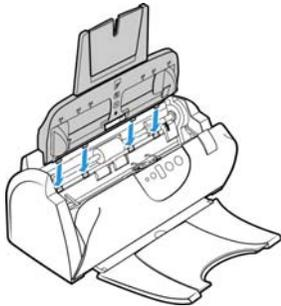
11. Presione la bandeja hacia atrás hasta que se inserte completamente en su posición.
