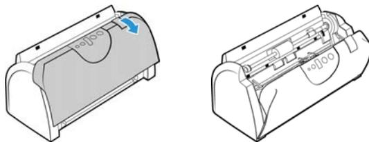
5. Alinee las lengüetas de la bandeja de entrada con las ranuras del interior del escáner y deslice la bandeja hacia abajo hasta su posición. Gire hacia atrás la guía del papel hasta que encaje en su posición.
