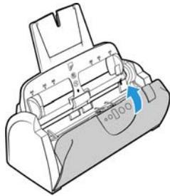
7. Inserte los pasadores a ambos lados de la bandeja de salida en los orificios del escáner.
