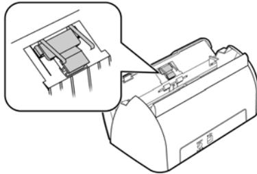
3. Presione las abrazaderas plásticas que mantienen el ensamblaje de la almohadilla en su posición y levante la almohadilla para extraerla. Invierta el procedimiento para instalar la almohadilla.
