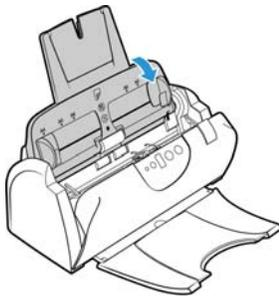
3. El rodillo se mantiene en su posición mediante una lengüeta de bloqueo que gira para bloquearlo y desbloquearlo. Para desbloquear la lengüeta, gírela hacia arriba hasta que la pestaña de bloqueo pequeña esté completamente libre.
