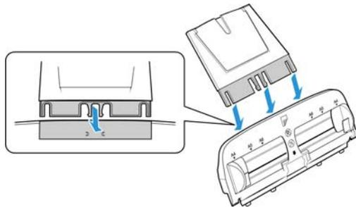
4. Aprire il coperchio dell'ADF e rimuovere con cura qualsiasi materiale protettivo all'interno del coperchio. Lasciare aperto il coperchio per poter inserire il cassetto di input.
