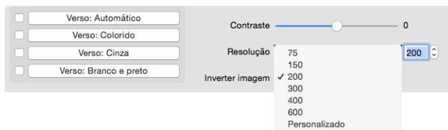
A resolução determina a quantidade de detalhes que poderão ser vistos na imagem digitalizada. A resolução é a clareza da imagem medida em pontos por polegada (dpi).
