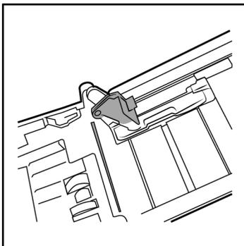
4. O rolamento inferior é mantido no lugar com uma aba de travamento que gira para travar e destravar. Para destravar a aba, gire-a até que o aro de travamento pequeno esteja completamente solto.
