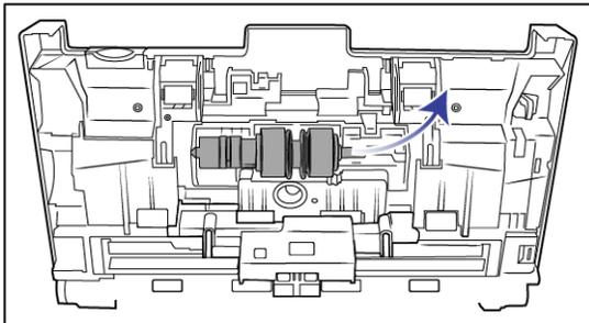
5. Remova o rolamento de substituição da barra.
