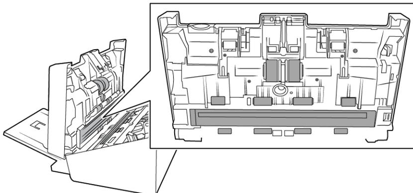
5. Com um cotonete limpo e seco, limpe os sensores de detecção de alimentação dupla.
