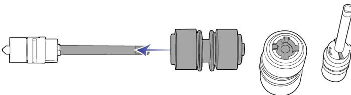
9. Insira a extremidade arredondada do rolamento no slot do scanner. Insira o rolamento no scanner. Certifique-se de que a ranhura do lado direito da barra esteja alinhada, para que ela possa ser inserida no suporte em formato de U.
