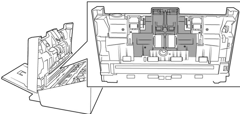
3. Drücken Sie auf die Seiten der Walzenabdeckung, und ziehen Sie sie nach unten, um Zugang zu der Walze zu haben.
