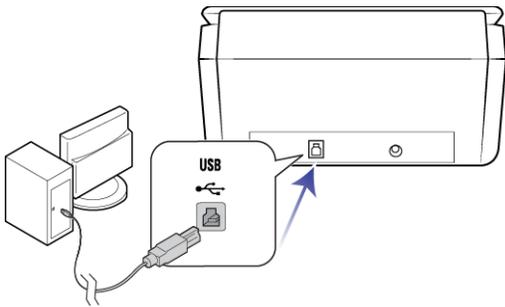
Wenn der Stecker nicht ohne Widerstand eingesteckt werden kann, vergewissern Sie sich, dass Sie ihn korrekt und in den richtigen Anschluss stecken. Drücken Sie den Stecker nicht gewaltsam in den Anschluss.
