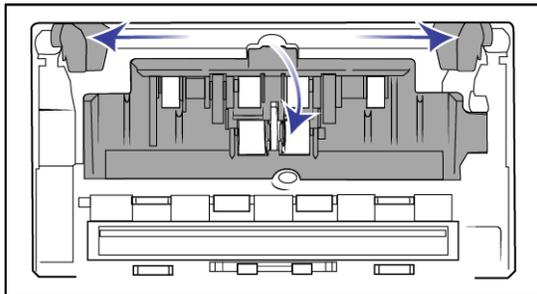
**Hinweis:** Wenn die Papierführungen sich beim Öffnen vor dem Walzendeckel befinden, werden sie automatisch aus dem Scannergehäuse freigegeben. Ist dies der Fall, folgen Sie den Anweisungen auf Seite 32 zum Zurücksetzen der Führungen im Scanner.
