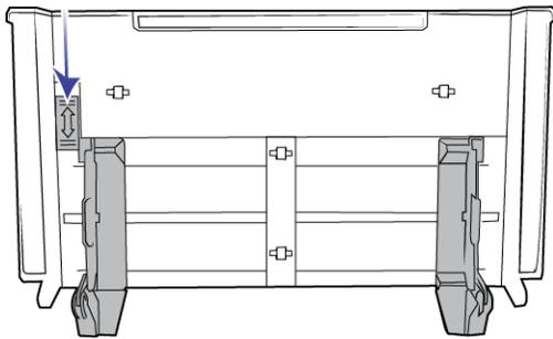
Wenn sich der Schalter für die Papierführung in der unteren Position befindet, können die Papierführungen bis zu einer Breite von maximal 216 mm (8,5 Zoll) angepasst werden. Wenn die Papierführungen breiter als die maximale Einstellung für reguläres Papier eingestellt werden, werden die Vorlagen beim Scannen vielleicht zu schief eingezogen.
