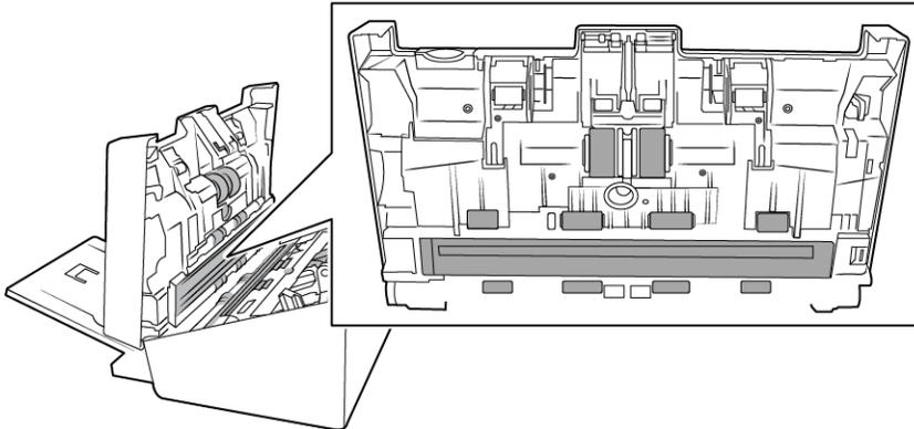
5. Entfernen Sie mit einem sauberen, trocken Baumwolltuch sämtlichen Staub an den Erkennungssensoren für die doppelte Vorlagenzufuhr.
