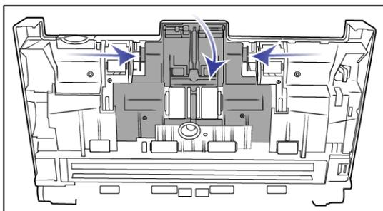
4. Heben Sie die Walze vorsichtig angewinkelt an, und entnehmen Sie sie aus dem Scanner.
