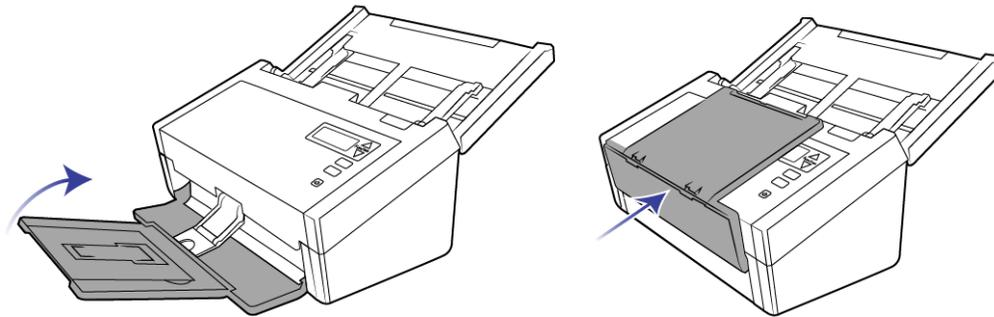
4. Klappen Sie die Papierführungen ein, sodass sie flach am Vorlagenfach anliegen.
