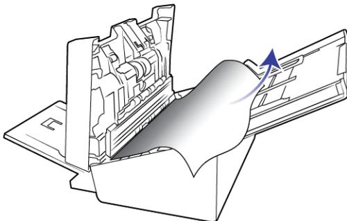
Sie können Papierstaus vermeiden, indem Sie das Papier vor dem Scannen glätten und ausrichten, die Führungsschienen an das Papierformat anpassen und das Papier gerade in den automatischen Vorlageneinzug einlegen.
