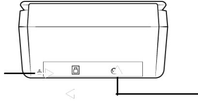
Schließen Sie über diesen Steckplatz ausschließlich das im Lieferumfang enthaltene USB-Kabel an den Scanner an. Verwenden Sie keine andere Art von USB-Kabel. Versuchen Sie nicht, ein Sicherheitsschloss mit diesem Anschluss zu verbinden.
