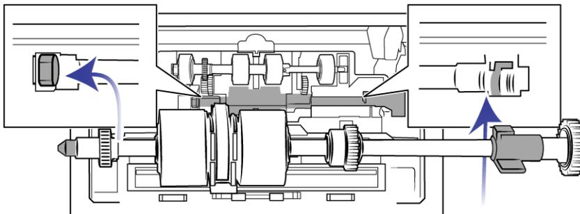
8. Gire a aba de travamento no slot do scanner. Pressione a alavanca até encaixar no lugar e travar o rolamento na porta do scanner.
