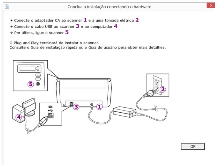
**Observação:** Se você não vir este diagrama na tela para conectar o scanner, pare e siga as instruções da próxima seção para conectá-lo.
