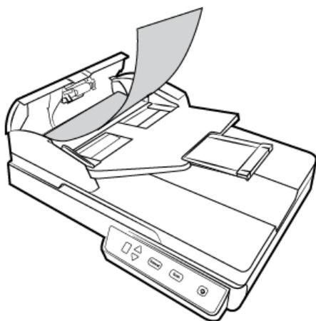
3. Fermez le couvercle de l'AAD. Appuyez doucement sur le couvercle de l'AAD jusqu'à ce qu'il s'enclenche avec un déclic.
