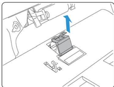
5. Retirez le ressort de tension situé sous le tampon de l'AAD.
