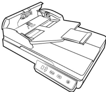
4. Fermez le couvercle de l'AAD. Appuyez doucement sur le couvercle de l'AAD jusqu'à ce qu'il s'enclenche avec un déclic.
