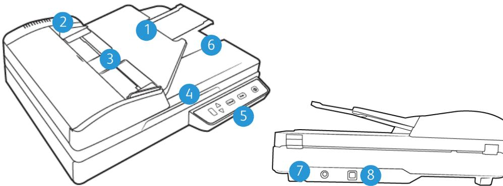
1. **Vorlagenfach:** Hält die Vorlagen in der korrekten Position im Scanner. Kann ausgeklappt werden, um Vorlagen verschiedener Längen zu halten.
