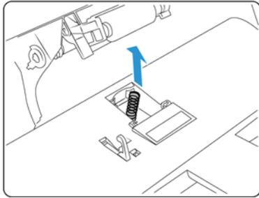
6. Coloque el resorte de tensión nuevo en el escáner.
