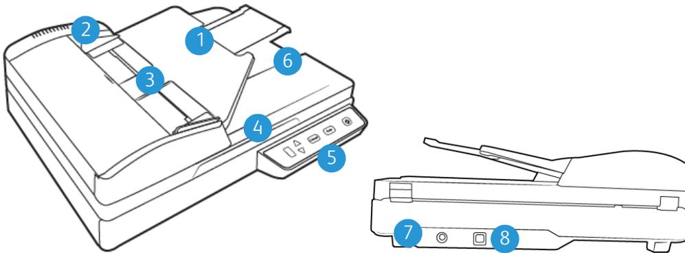
1. **Bandeja de entrada:** mantiene el papel en el escáner. Se despliega para admitir papel de distintas longitudes.
