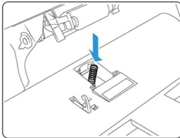
7. Coloque a nova almofada do ADF no scanner e gire para encaixar.
