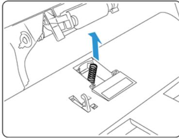
6. Coloque a nova mola de tensão no scanner.
