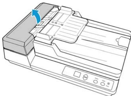
3. Wischen Sie die Einzugwalze nach einer Seite ab. Drehen Sie die Walze, um die gesamte Oberfläche zu reinigen. Die Einzugwalze befindet sich an der Unterseite der Klappe des automatischen Vorlageneinzugs.
