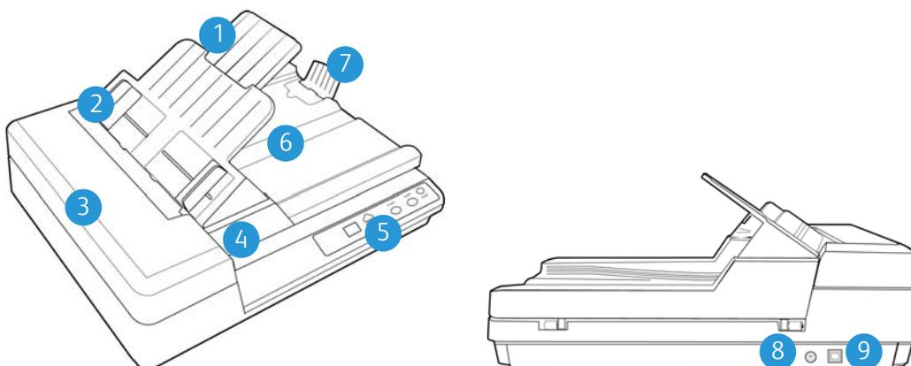
1. **Vorlagenfach:** Hält die Vorlagen in der korrekten Position im Scanner. Kann ausgeklappt werden, um Vorlagen verschiedener Längen zu halten.
