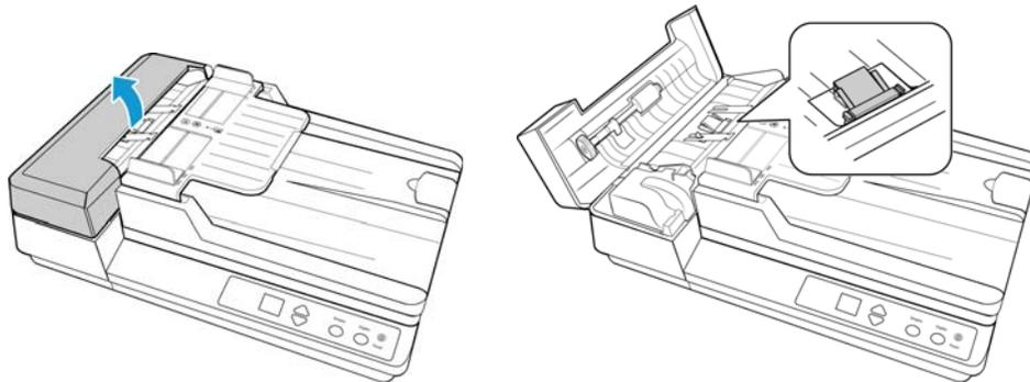
2. Drücken Sie die Kunststoffklammern zusammen, mit denen das Pad befestigt ist, und entnehmen Sie es. Gehen Sie zum Einsetzen des neuen Pads in umgekehrter Reihenfolge vor.
