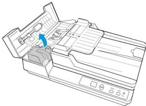
5. Reinigen Sie den Glasstreifen an der Unterseite des Duplex-Lampenmoduls. Reinigen Sie den Glasstreifen im Scannergehäuse.
