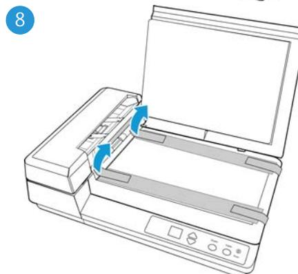
2. Klappen Sie das Vorlagenfach nach oben weg vom Scannergehäuse.
