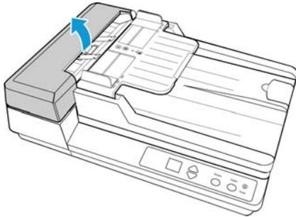
2. Heben Sie das Duplex-Lampenmodul an, um Zugriff auf die Unterseite des automatischen Vorlageneinzugs zu erhalten.
