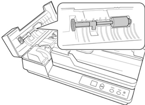
3. Die Walze ist mit einem Sicherungsriegel gesichert, der zum Verriegeln und Entriegeln gedreht werden kann. Drehen Sie den Sicherungsriegel zum Entriegeln nach oben, bis der kleine Sicherungsflansch vollständig frei liegt.
