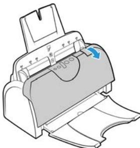
3. Limpie estos rodillos de un lado a otro. Gire los rodillos hacia abajo para limpiar toda la superficie. Limpie con un paño la sección de vidrio en el cuerpo del escáner.
