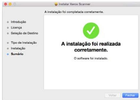
**Obs. técnica:** a tela Instalação concluída pode ser em branco ao instalar no OS X v. 10.9. Feche a tela vazia e prossiga com a conexão do scanner ao computador.
