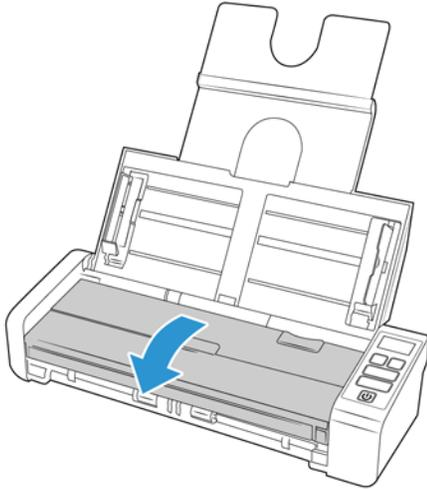
2. Suchen und öffnen Sie die Walzenabdeckung im Gehäuse des Scanners.
