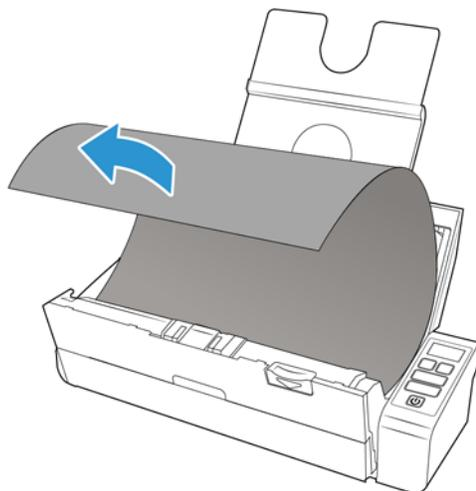
Sie können Papierstaus vermeiden, indem Sie das Papier vor dem Scannen glätten und ausrichten, die Führungsschienen an das Papierformat anpassen und das Papier gerade in den automatischen Vorlageneinzug einlegen.
