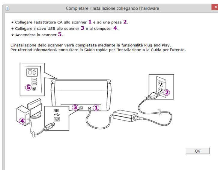
**Nota:** Se il diagramma di connessione dello scanner riportato di seguito non viene visualizzato sullo schermo, arrestarsi e seguire le istruzioni descritte nella sezione seguente per la connessione dello scanner.
