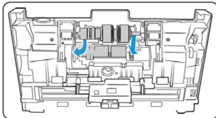
10. Sollevare il coperchio del rullo e spingerlo con delicatezza per chiuderlo e bloccarlo in posizione. Assicurarsi che tutti i componenti siano allineati correttamente e chiudere completamente il coperchio. Se il coperchio non è completamente chiuso, potrebbe rompersi durante la scansione e danneggiare lo scanner.
