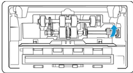
9. Sollevare il coperchio del rullo e spingerlo con delicatezza per chiuderlo e bloccarlo in posizione. Assicurarsi che tutti i componenti siano allineati correttamente e chiudere completamente il coperchio. Se il coperchio non è completamente chiuso, potrebbe rompersi durante la scansione e danneggiare lo scanner.
