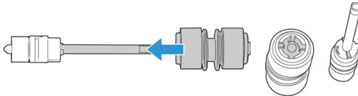
9. Inserire l'estremità arrotondata del rullo nell'alloggiamento dello scanner. Abbassare con cautela il rullo nello scanner. Assicurarsi che la scanalatura sul lato destro della barra sia allineata in modo da consentirne lo scorrimento in posizione nella parte a forma di U della staffa.
