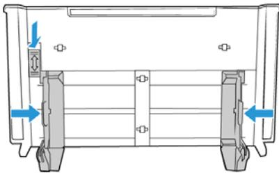
Quando l'interruttore si trova in posizione abbassata, le guide possono essere regolate fino a una larghezza massima di 216 mm (8,5 pollici). Se le guide sono impostate su un valore superiore a quello massimo per il formato regolare, i documenti potrebbero inclinarsi eccessivamente durante la scansione.
