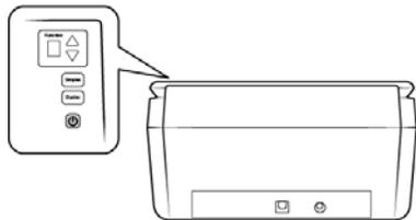
L'indicatore di stato inizia a lampeggiare per indicare che lo scanner è alimentato.
