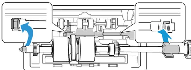
8. Ruotare la linguetta di blocco nella fessura dello scanner. Tirare la leva fino a quando non scatta in posizione e blocca il rullo nello scanner.
