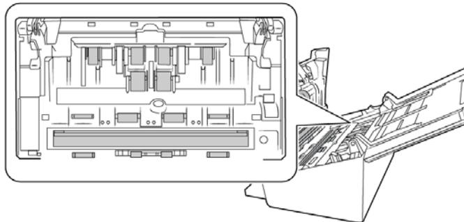
4. Pulire i rulli e il piano fisso nella parte inferiore dello sportello dell'ADF. Ruotare i rulli per pulirne tutta la superficie.
