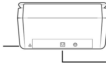
Utilizzare questo slot per collegare il cavo micro USB allo scanner. Non utilizzare altri tipi di cavo USB. Non tentare di installare una serratura di sicurezza in questa porta.
