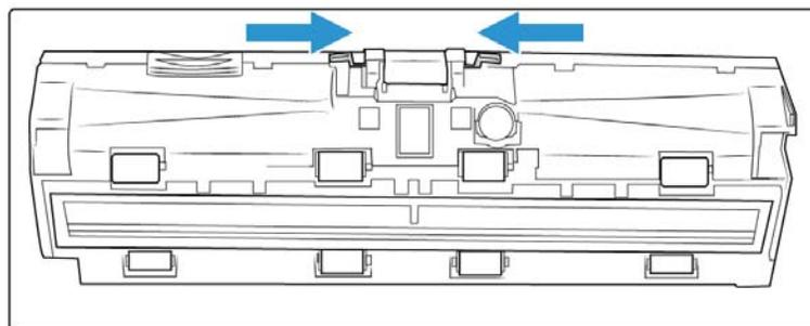
4. Heben Sie das Pad an, und entnehmen Sie es aus dem Scanner.
