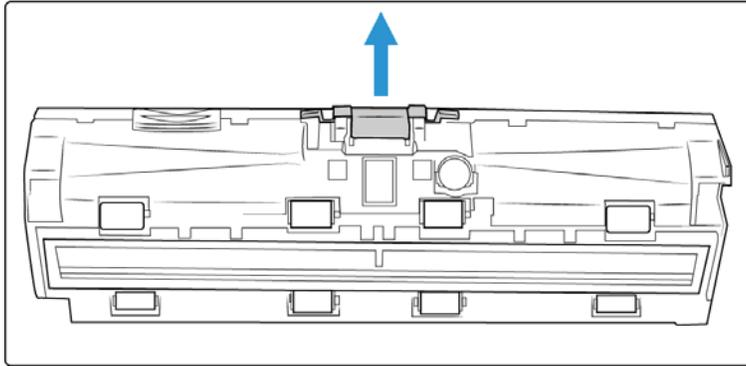
5. Platzieren Sie das neue ADF-Pad im Scanner
