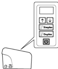
Die Statusleuchte blinkt. Damit wird angezeigt, dass der Scanner mit Strom versorgt wird.
