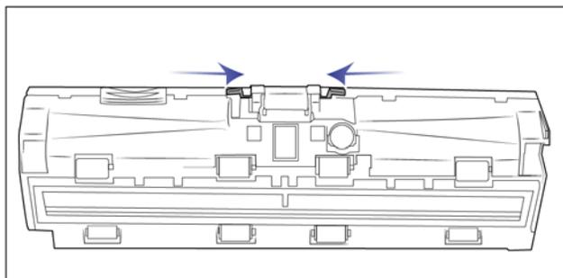
4. Heben Sie das Pad an, und entnehmen Sie es aus dem Scanner.
