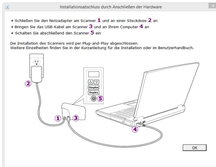
**Hinweis:** Wenn dieses Anschlussdiagramm für den Scanner nicht auf dem Bildschirm angezeigt wird, brechen Sie den Installationsvorgang ab, und folgen Sie den Anweisungen zum Anschließen des Scanners im nächsten Abschnitt.
