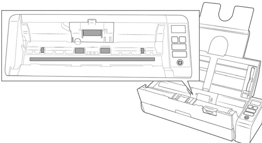
4. Wischen Sie die Walzen und das Glas an der Unterseite der Klappe des automatischen Vorlageneinzugs sauber. Drehen Sie die Walzen, um die gesamte Oberfläche zu reinigen.
