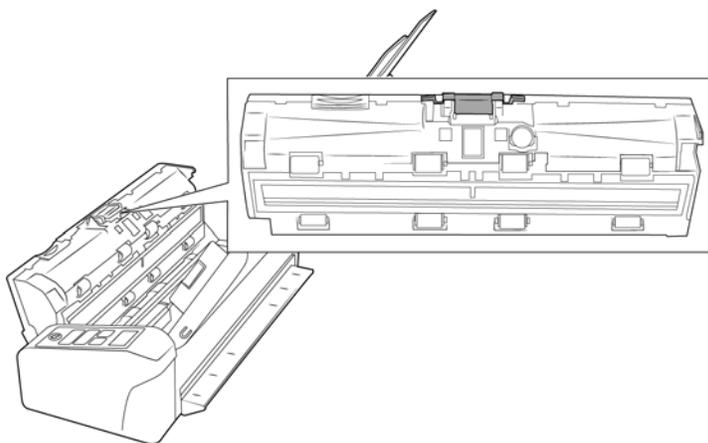
3. Drücken Sie die Kunststoffklammern zusammen, mit denen das Pad befestigt ist.
