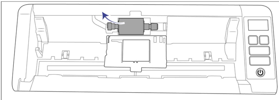
5. Entnehmen Sie die neue Walze aus der Verpackung. Entfernen Sie vor dem Befestigen sämtlichen Staub von der Walze.
