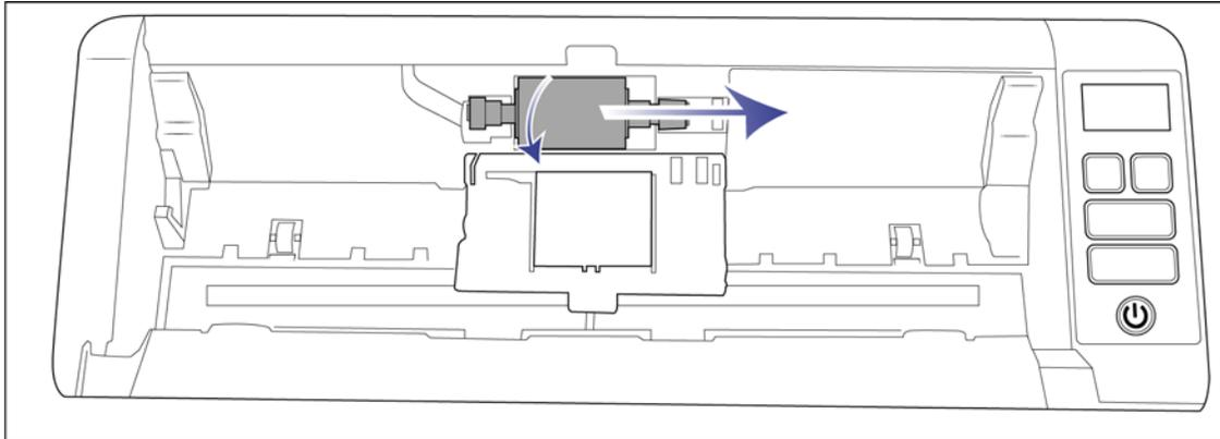
8. Heben Sie den Walzendeckel, und drücken Sie ihn vorsichtig zu, Vergewissern Sie sich, dass alles richtig ausgerichtet und der Deckel vollständig geschlossen ist. Wenn der Deckel nicht vollständig geschlossen ist, wird er beim Scannen brechen und den Scanner beschädigen.
