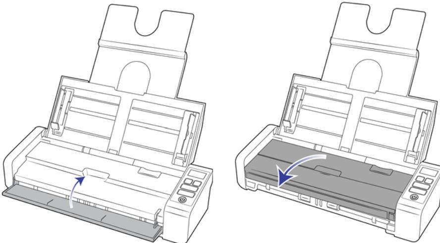
3. Wischen Sie die Walzen und das Glas im Scannergehäuse sauber. Drehen Sie die Walzen, um die gesamte Oberfläche zu reinigen.
