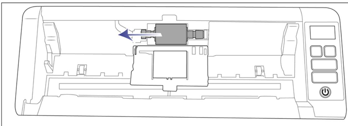
4. Winkeln Sie die Walze nach oben an, und entnehmen Sie sie aus dem Scanner. Entsorgen Sie sie dann, da sie nicht repariert werden kann.
